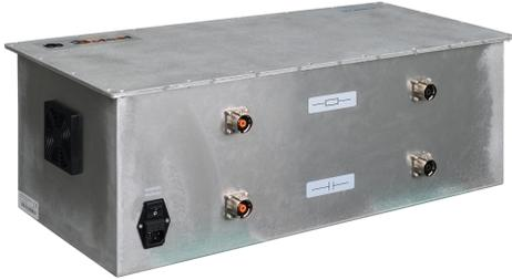
7637-4R500/120 产品满足 ISO 7637-4 中 A 波、B 波、C 波中匹配阻抗和回路电容的要求，可单独使用电阻或者电容，也可将电阻电容并联到回路使用。
